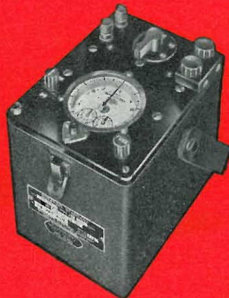
Fig. 4 - Contatore campione portatile
