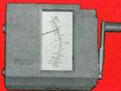
Fig. 7 - Misuratore di isolamento tascabile
