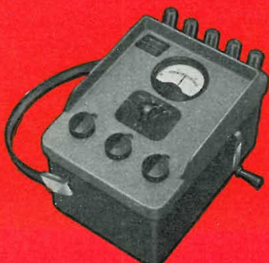
Fig. 9 - Misuratore di terre ad azzeramento
